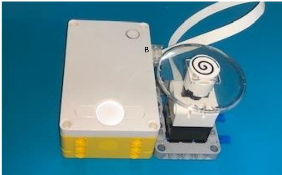
Para realizar un dado vamos a utilizar solo un sensor de color que hemos conectado en el puerto “B”.
